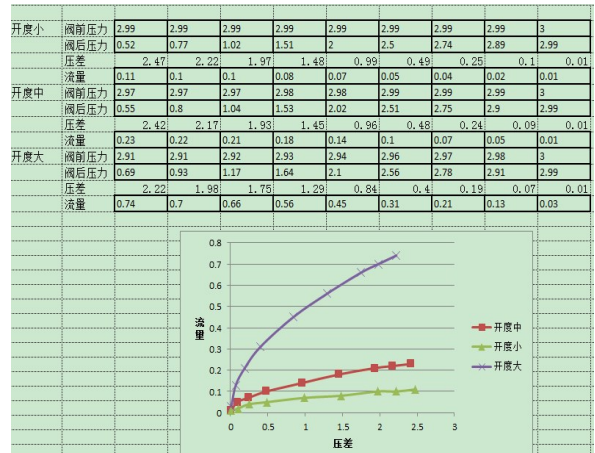
图3 节流阀调速时在不同开度下流量与压差的关系
